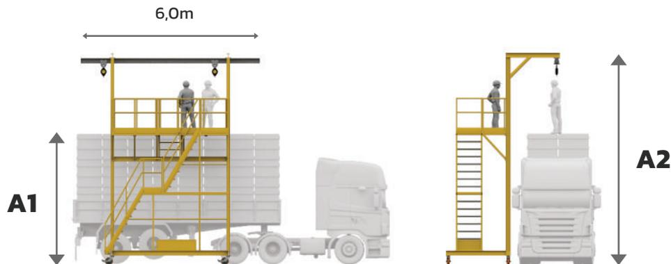
Feita em Aço SAE1020 reforçado e com rodízios para movimentação em piso nivelado e bem-acabado.
