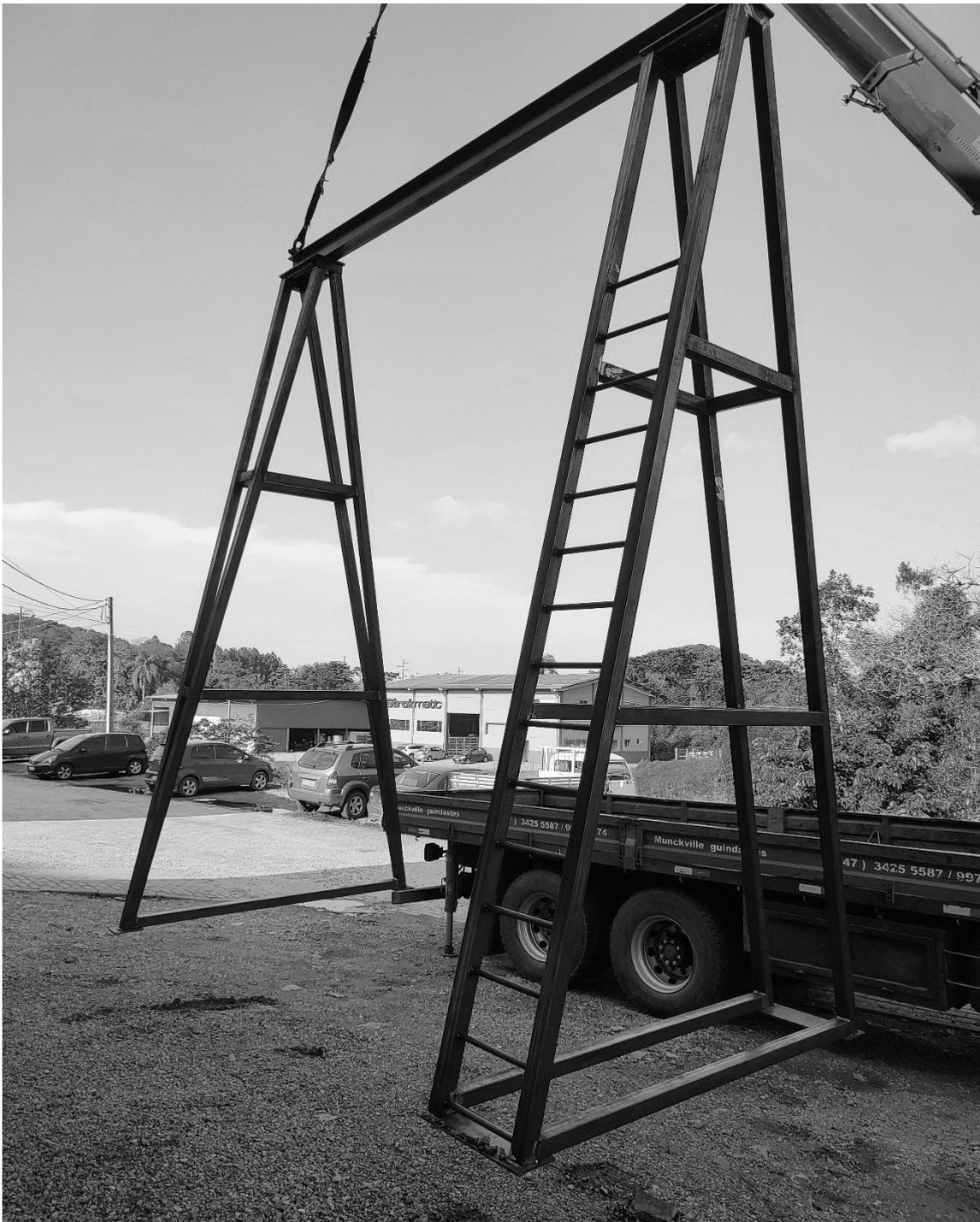
Para chumbamento, a furação da base precisa ser diferente da furação para fixação dos rodízios, portanto, precisa ser informada a forma de apoio antes da fabricação.
