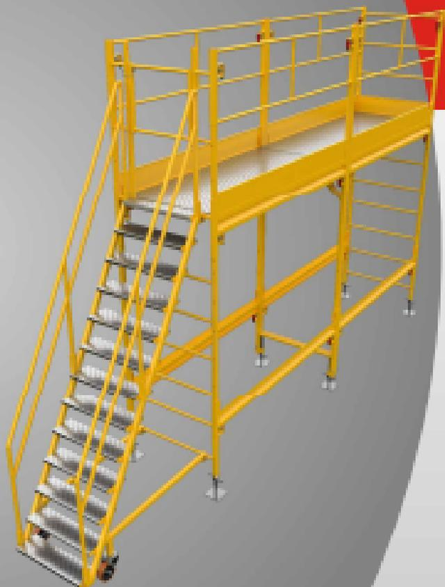
A montagem da estrutura se dá por módulos de 2,3m de comprimento, permitindo uma combinação tão longa quanto necessário, ideal para manutenções em grandes máquinas, locomotivas e inspeções de cargas em caminhões.
