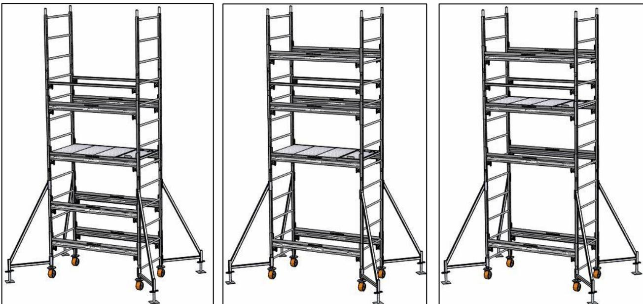
**8.17** – Transferir as laterais de tubo para cima, montando o guarda-corpo superior da plataforma.
